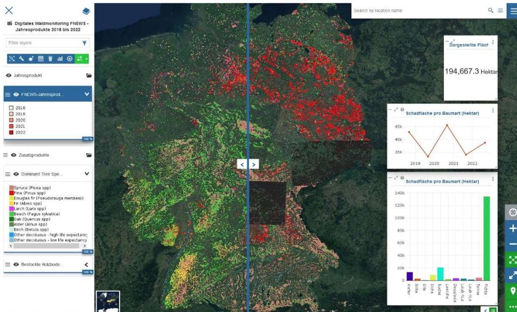
Abbildung 22: Beispieldarstellung des Waldschadensproduktes. Räumliche und zeitliche Statistiken der Jahresprodukte 2018 bis 2022 aus den Untersuchungsgebieten. Links die Legende der eingeblendeten Karten. Rechts die Ergebnisdigramme der räumlichen Abfrage als Balken- und Liniendiagramm sowie als Summenfunktion
